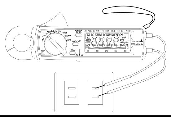
**Attention**: l'entrée maximale en VDC et VAC est de 600V. Ne pas essayer de mesurer des tensions supérieures à cette limite. Dans le cas contraire, il existe un risque de choc électrique et d'endommagement de l'appareil.
