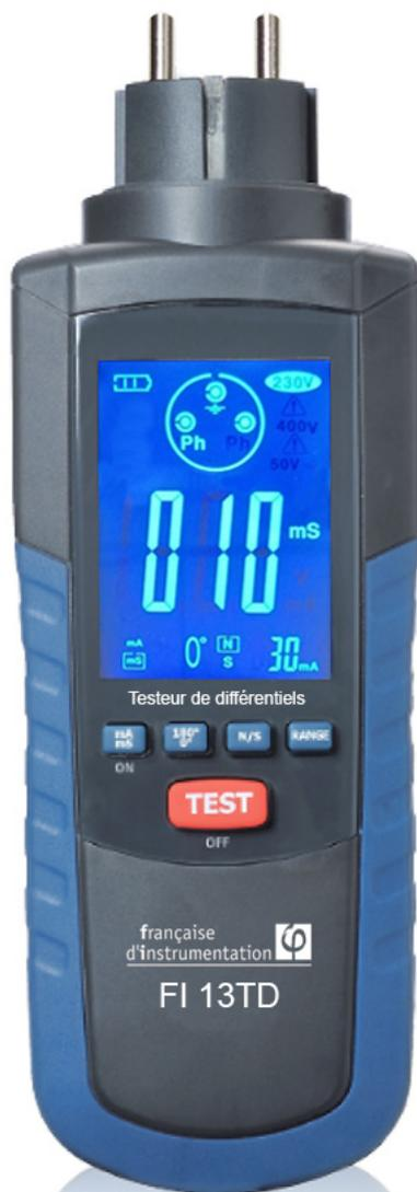
Le testeur FI 13TD permet de contrôler et de mesurer **le temps et le courant de déclenchement** des dispositifs de protection à courant différentiel résiduel (DDR) de sensibilité **10, 30, 300, 500 et 650 mA** qu'ils soient de type N (**normal**) ou S (**retardé**).
