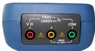
Le testeur FI 19TT permet de contrôler la résistance du piquet de terre d'une installation électrique en toute sécurité selon **la méthode classique à piquets**. Il peut également être utilisé pour mesurer une tension alternative ou continue et une résistance, ce qui en fait un instrument très polyvalent.
