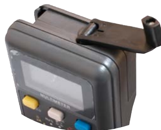
Dynamo pour génération de l'énergie d'alimentation du multimètre
