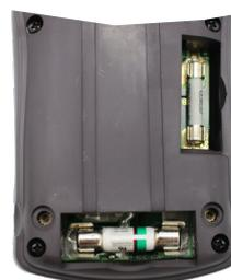
◀ Protection des entrées courant par fusibles HPC facilement accessibles
