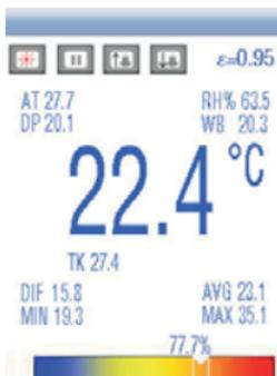
Mesure la température IR et le point de rosée.
