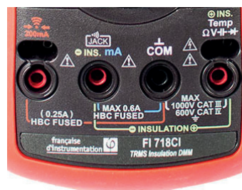
Bornes avec connectique spéciale pour télécommande
