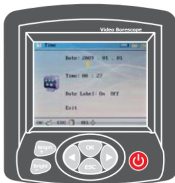
Déplacer le curseur sur la fonctions que vous souhaitez paramétrer, à l'aide des touches directionnelles. Puis appuyer sur les boutons «PHOTO» et «VIDEO» pour ajuster la date et l'heure. Sélectionner «OFF» sur le réglage de l'heure pour désactiver l'horodatage à l'écran. Appuyer sur «OK» pour sauvegarder l'heure paramétrée et revenir à l'interface principale, ou alors appuyer sur «ESC» pour revenir au mode caméra.
