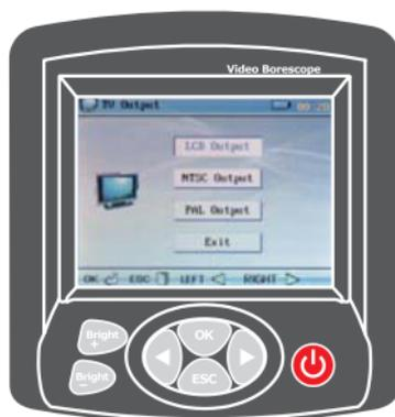
Sélectionner «NTSC» ou «PAL» en accord avec le format vidéo de la télévision, puis appuyer sur «OK» pour valider. Le contenu sera encore contrôlé à partir de l'appareil, mais affiché sur la télévision.
