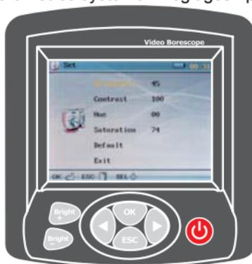
Appuyer sur les touches «PHOTO» et «VIDEO» pour incrémenter ou décrémenter la valeur, afin d'ajuster les réglages de la caméra (l'ajustement provoque un léger effet qui ne peut être identifié que dans le mode caméra). Ces ajustement ne sont pas conseillés pour un appareil venant d'être calibré avant livraison. Appuyer sur «Défaut» pour revenir aux réglages usine.
