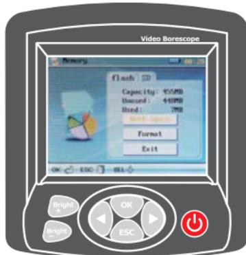
Appuyer sur «PHOTO» et «VIDEO» pour sélectionner la mémoire courante (SD / Flash), sélectionner «Espace de travail» et appuyer sur «OK» pour confirmer. Si une opération de formatage est nécessaire, sélectionner «Format» et appuyer sur «OK», une fenêtre de dialogue apparaîtra et il faudra sélectionner «Oui» pour valider le formatage.
