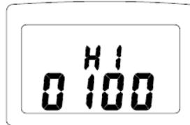
Utiliser les touches [▲] et [▼] pour incrémenter ou décrémenter le seuil d'alarme haute.
