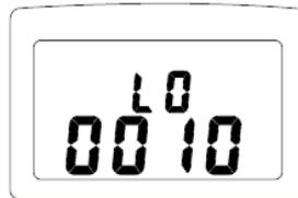
Utiliser les touches [▲] et [▼] pour incrémenter ou décrémenter le seuil d'alarme basse.
