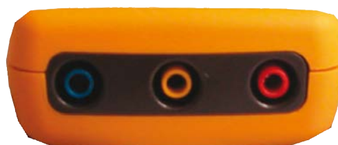
Repères avec code couleur pour les bornes et les cordons de mesure
